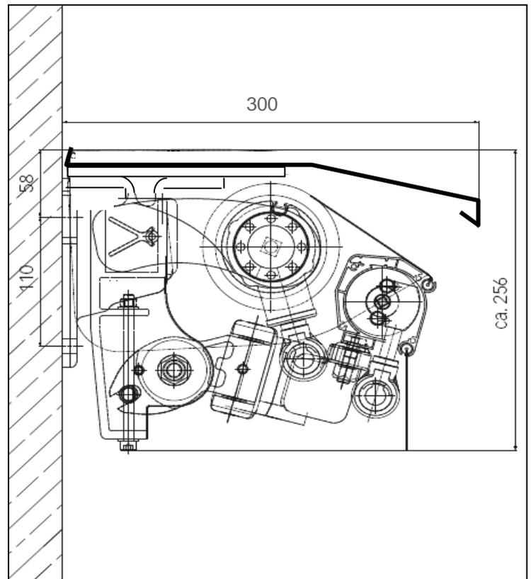
Montage en façade avec ou sans toit de protection et lame finale avec volant déroulable
